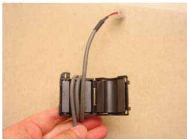
Рис. 25. Установка ферритового кольца на линии связи с разъемом типа RJ-11
