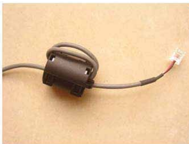
Рис. 25. Установка ферритового кольца на линии связи с разъемом типа RJ-11
