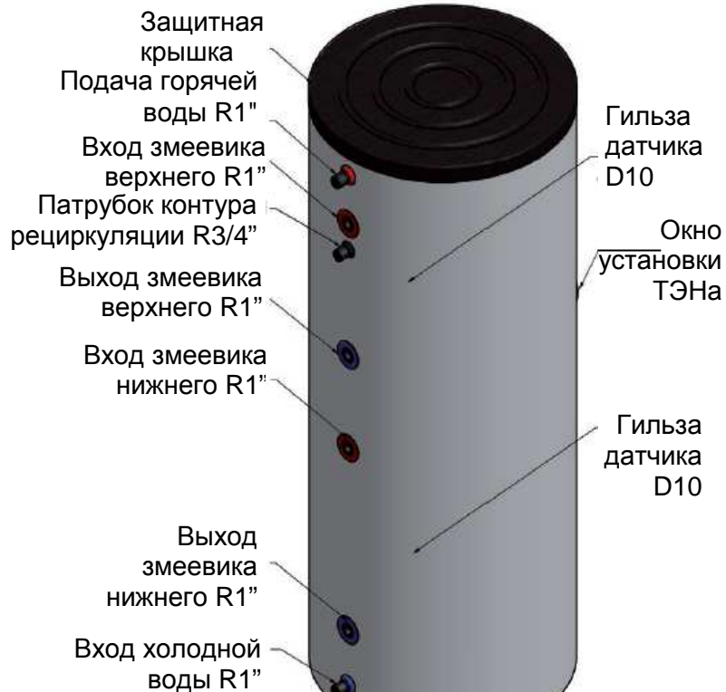
Водонагреватель с двумя теплообменниками-змеевиками 160-200 л
