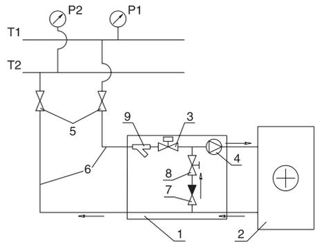
T1 и T2 – подающий и обратный трубопроводы сети холодоснабжения; 1 – узел обвязки; 2 – водяной охладитель;
