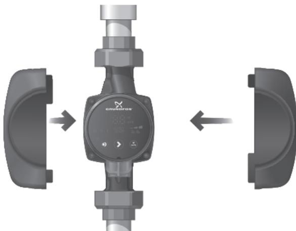
Рис. 24 Теплоизолирующие кожухи
